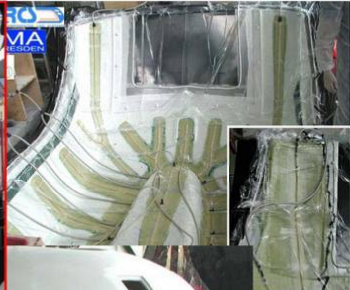
Gestrick- verstärkte A-Säule
