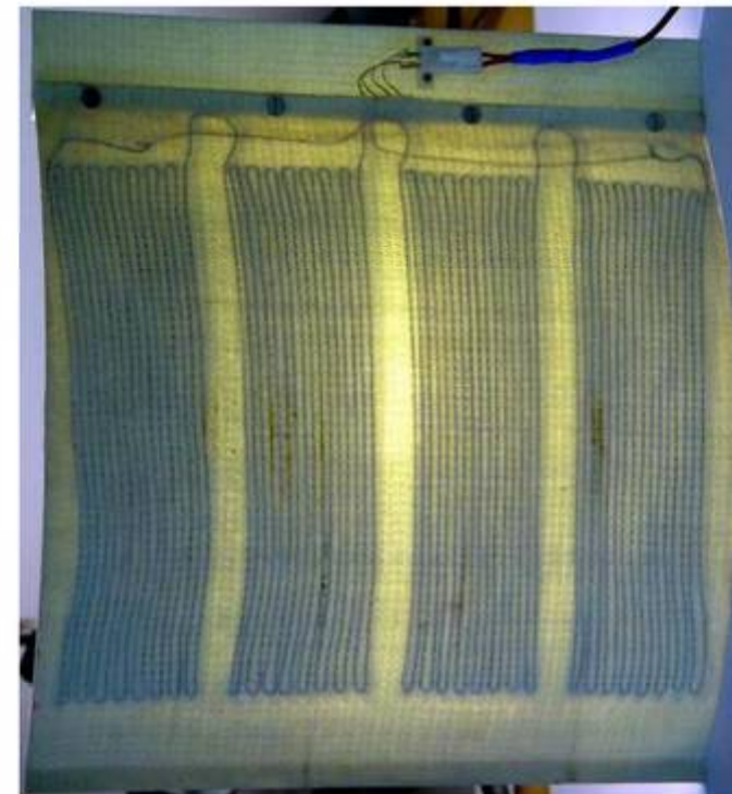
Verbundbauteil mit stricktechnisch integrierten CF-Dehnungssensoren
