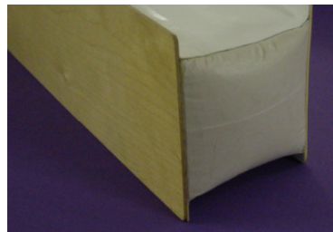
Flach gewebter, durch Luft in eine räumliche Form gebrachter textiler Träger
