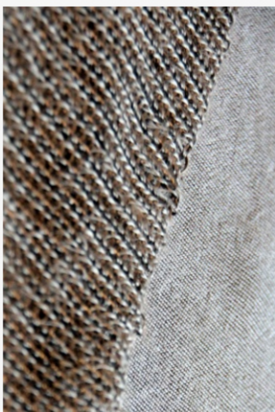
Gestrick aus Basalt: antibakterielle Eigenschaften bremsen unter der Wasserlinie den Anhaftungsprozess. (Quelle: Peterseim Strickwaren)
