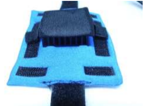
Abb 3.: Modul 2 mit zusätzlichen Kühlkissen
