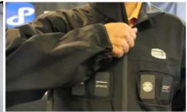
Abb 3.: TEGwear Jacke, eingearbeitete Thermogeneratoren versorgen drahtloses Vital-Monitoring
