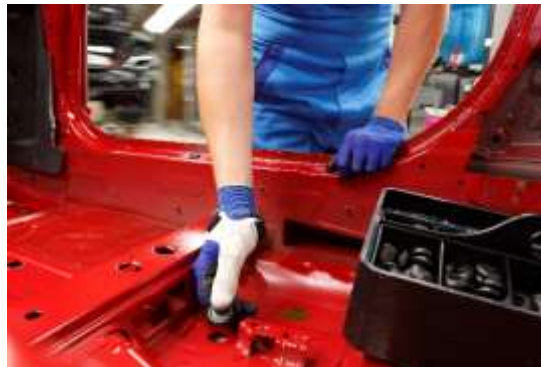
Abb 2.: Mitarbeiter beim Eindrücken eines Stopfen
