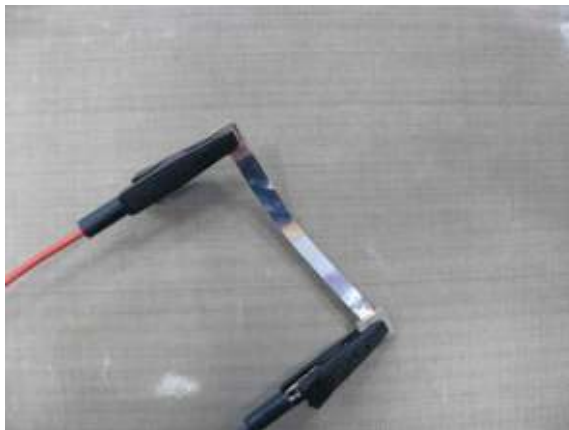
PVDF-Foliebändchen mit Elektroden Kontaktierung Verkapselung
