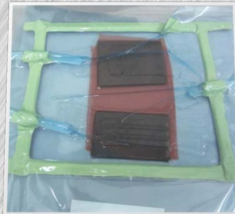
CFK während der Wiederauffüllung mit Epoxidharz → SCRIMP-Methode (Vakuuminfusion mit Fließhilfe)
