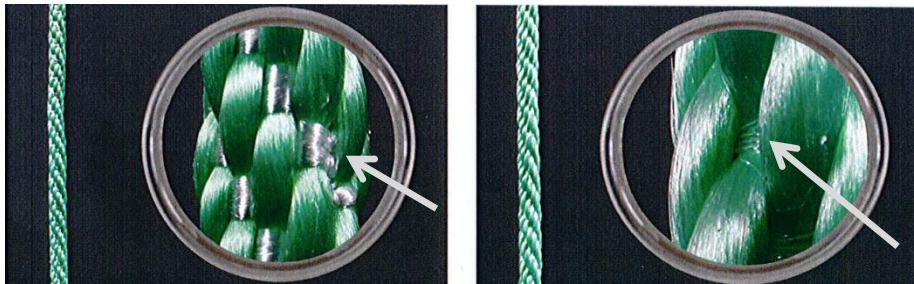
Verbindung der Seillängsfäden durch den Eintrag von Schussfäden in Querrichtung
