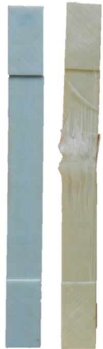
Probekörper, li. vorgeschädigt, re. totales Versagen
