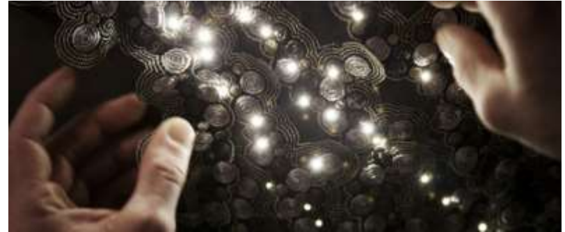
gestickte LEDs; Quelle: Forster & Rohner
