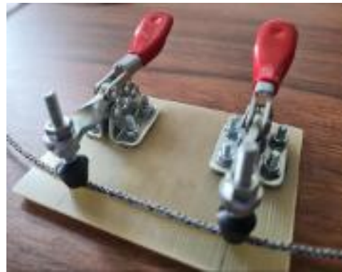
Es wurde vier temperatursensitive Filamente und ein Cellulose basierter Feuchtesensor kombiniert
