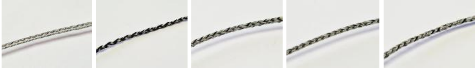
Es wurde vier temperatursensitive Filamente und ein Cellulose basierter Feuchtesensor kombiniert
