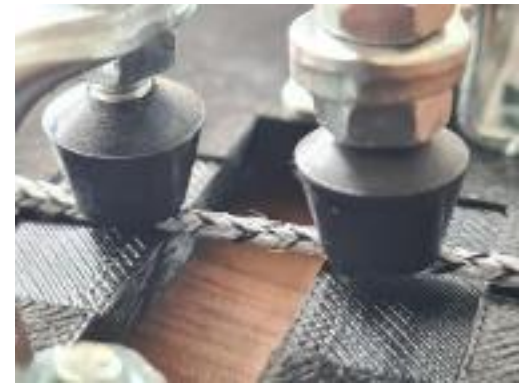
Es wurde vier temperatursensitive Filamente und ein Cellulose basierter Feuchtesensor kombiniert
