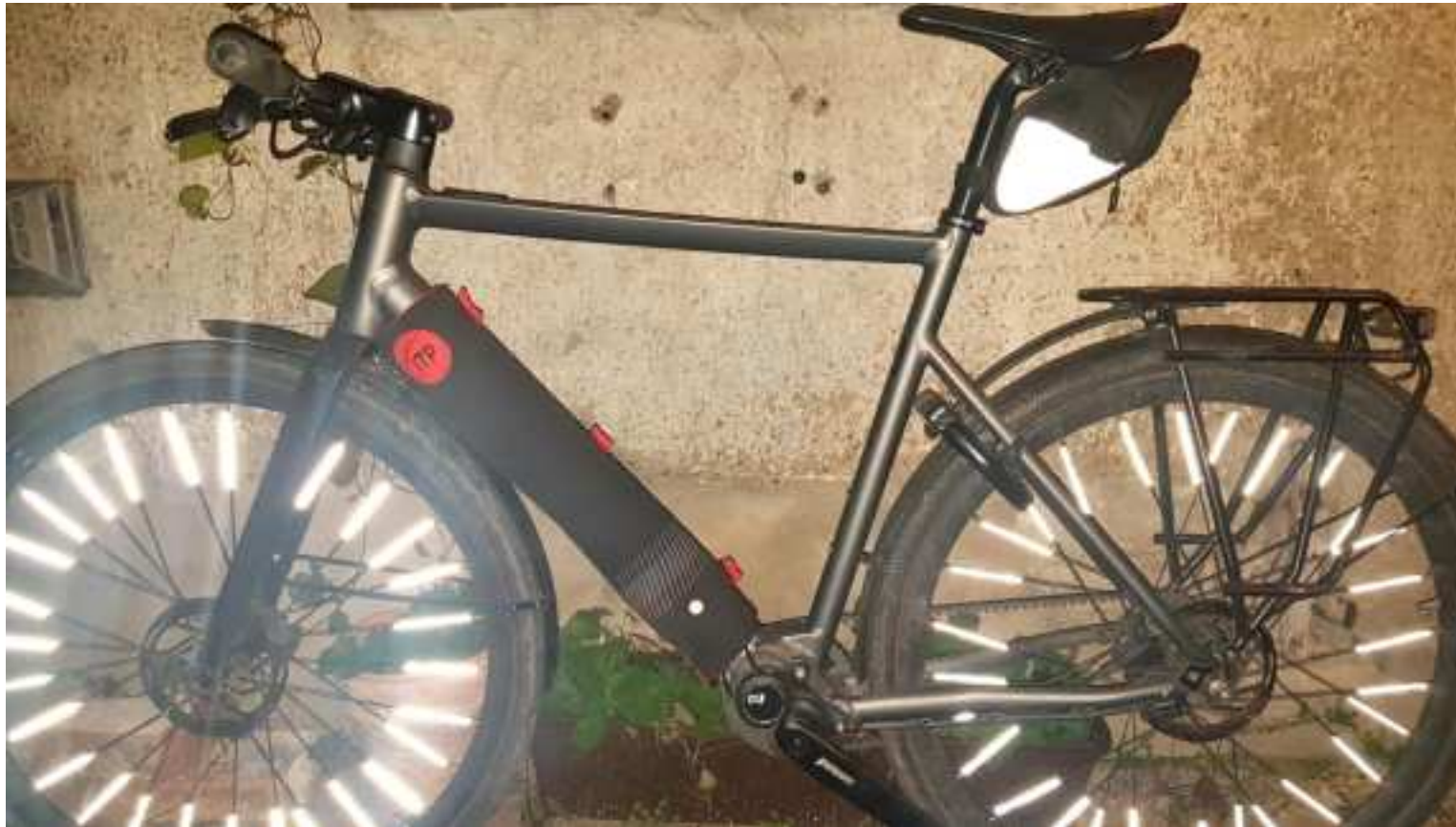
Abb. 19: Beheizbare Akku- Thermoschutzhülle an Fahrrad
