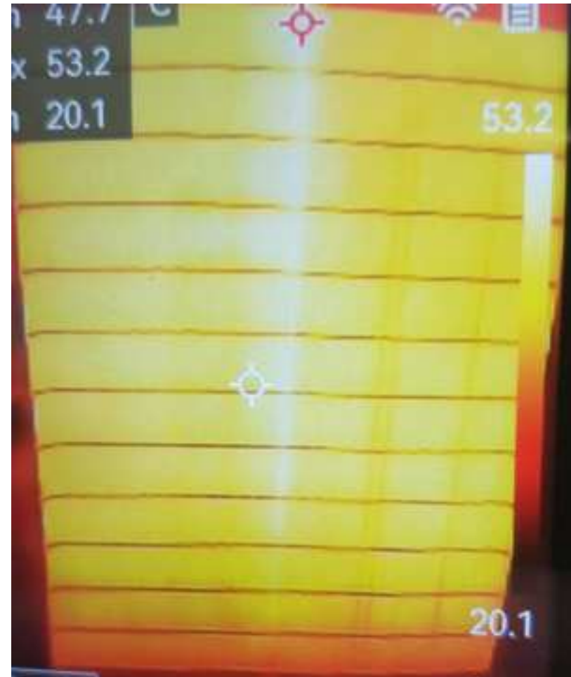
Abb. 10 : Heizgewebe von ITP - Infrarotaufnahme
