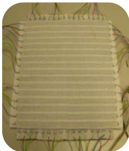
Textile 16x16 Matrix zur Druckerfassung mit zugehörigem Druckprofil eines Gesäßes
