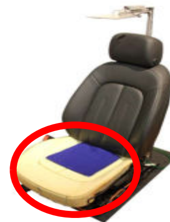
Drucksensitive Matrix 9 x 9 Messelemente auf Fahrzeugsitz liegend
