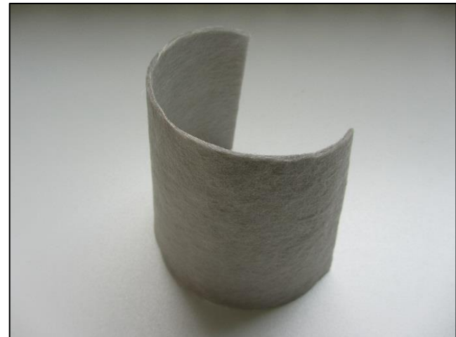
Dreidimensional verformtes keramisches Nassvlies
