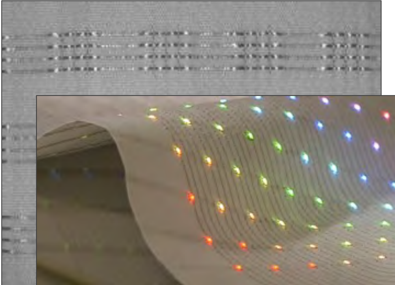
Gewebte Grundstruktur für eine Leuchfläche
