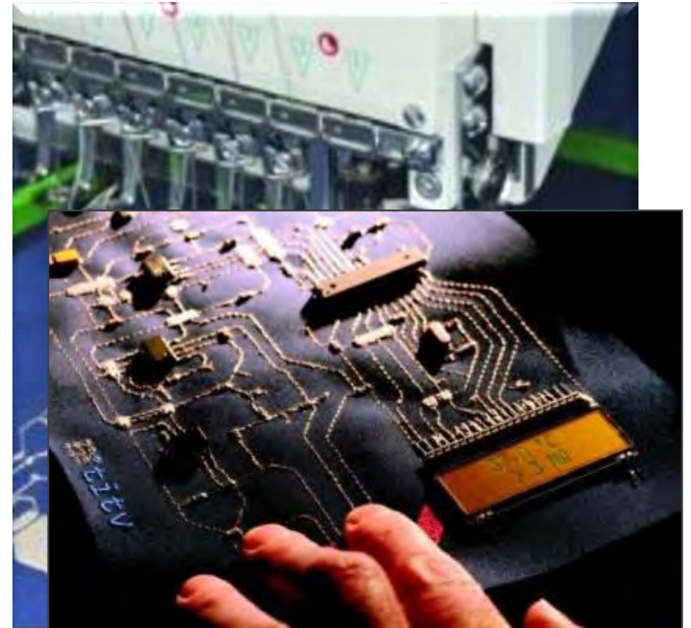
gesticktes Layout für Temperatur und Widerstandsmessung
