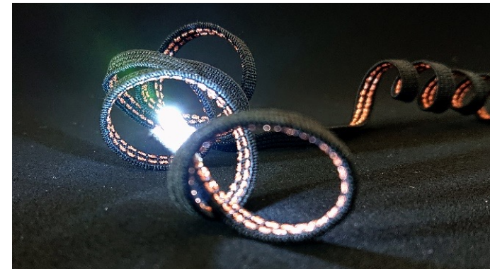
CondElastX: flexibler, elektrischer Leiter für Leuchtanwendungen
