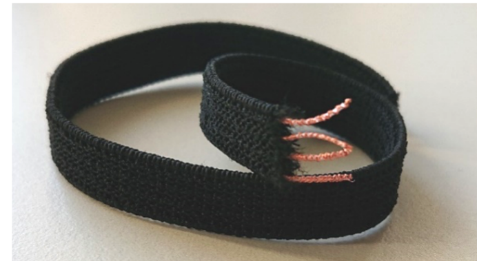
CondElastX: integriertes, leitfähiges Garn
