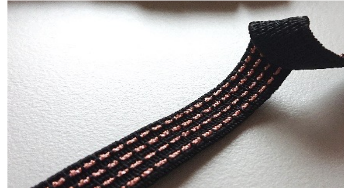
CondElastX: aufliegendes, leitfähiges Garn
