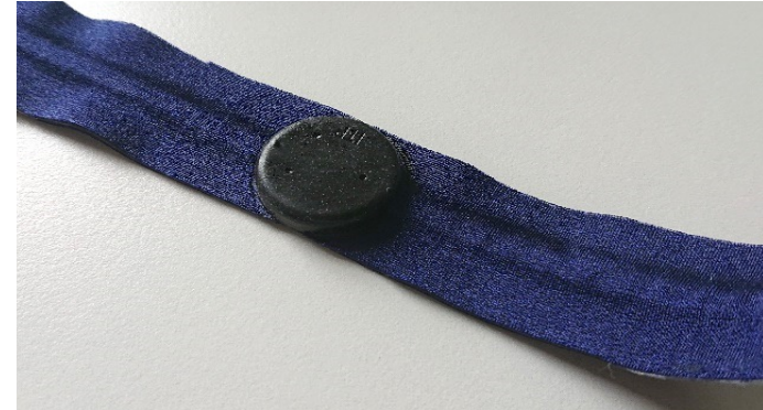
CondElastX: Anwendung als Sensorbus
